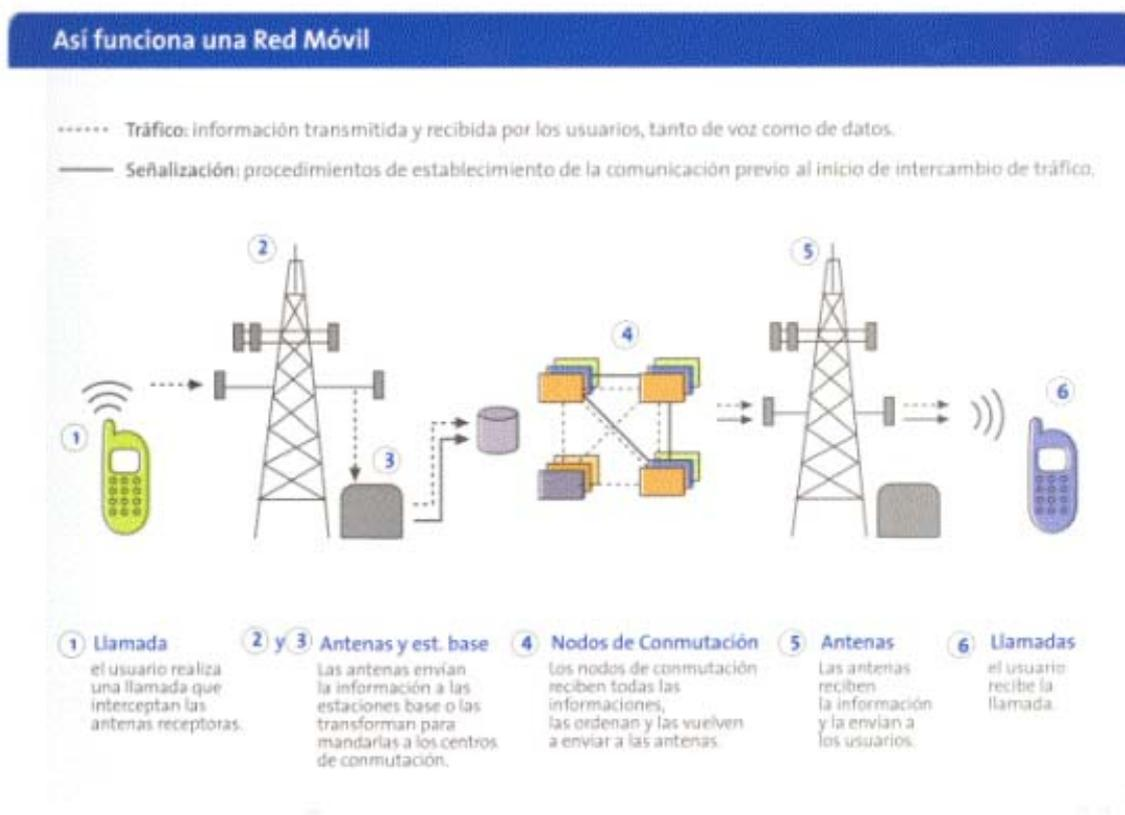
Para que la comunicación entre dos terminales móviles (teléfonos) sea posible, es necesario que exista una infraestructura que realice las conexiones: las estaciones base.
